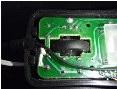
マウスボタンに配線
